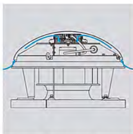
Sistema de autorrefrigerado Diseño especial para refrigerar el motor y alargar la vida del conjunto.
